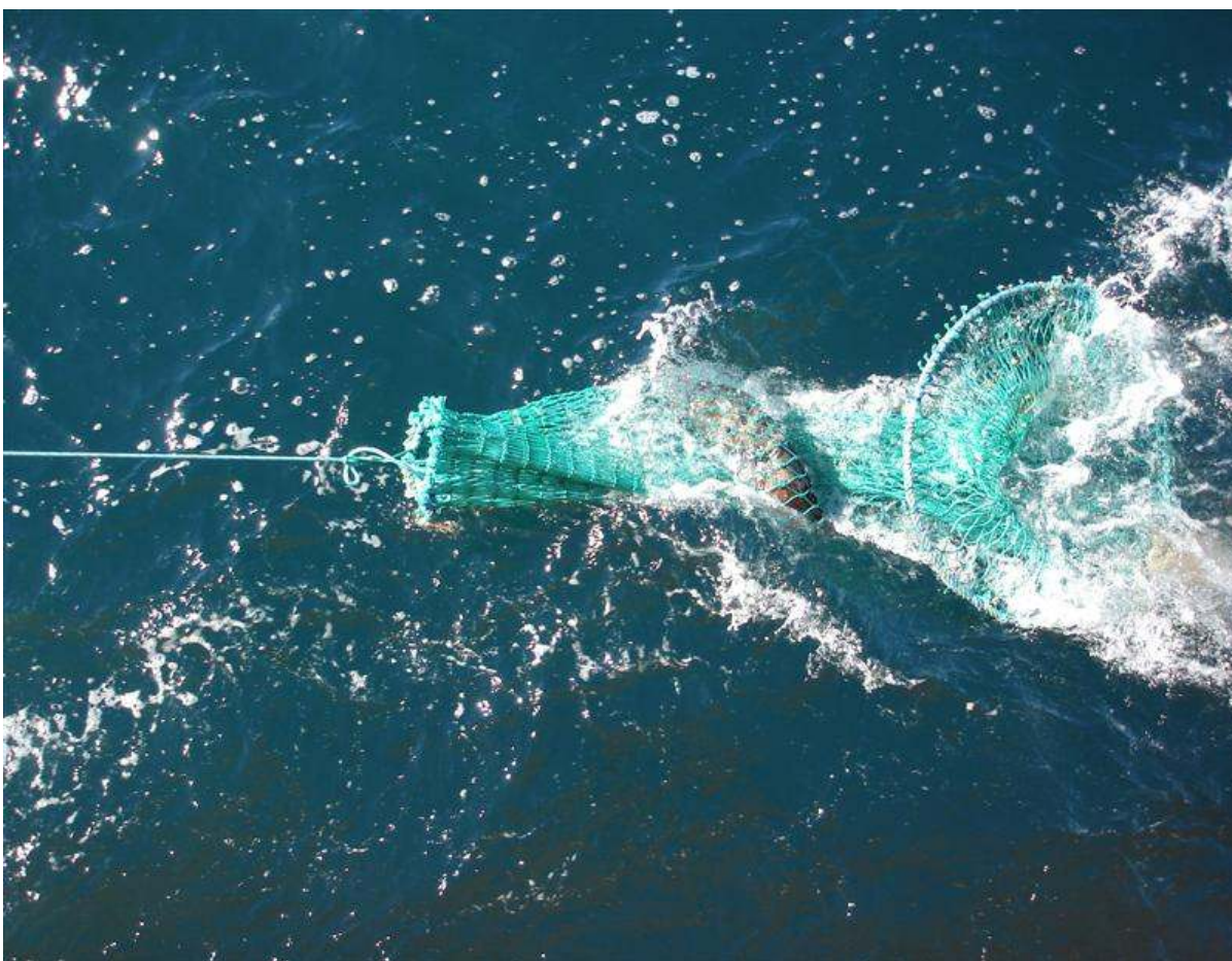
Figura 5. Red de protección de la captura DEMA en funcionamiento.
